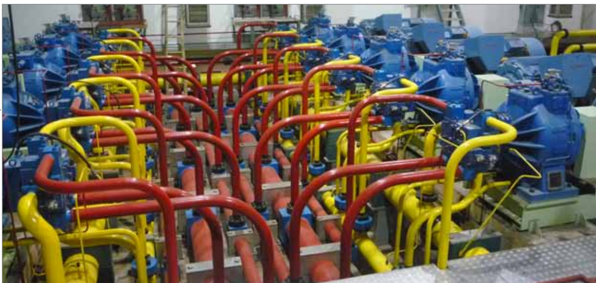
20-насосный-«PMSD»-привод («RX 500») для 185 МН прессы
