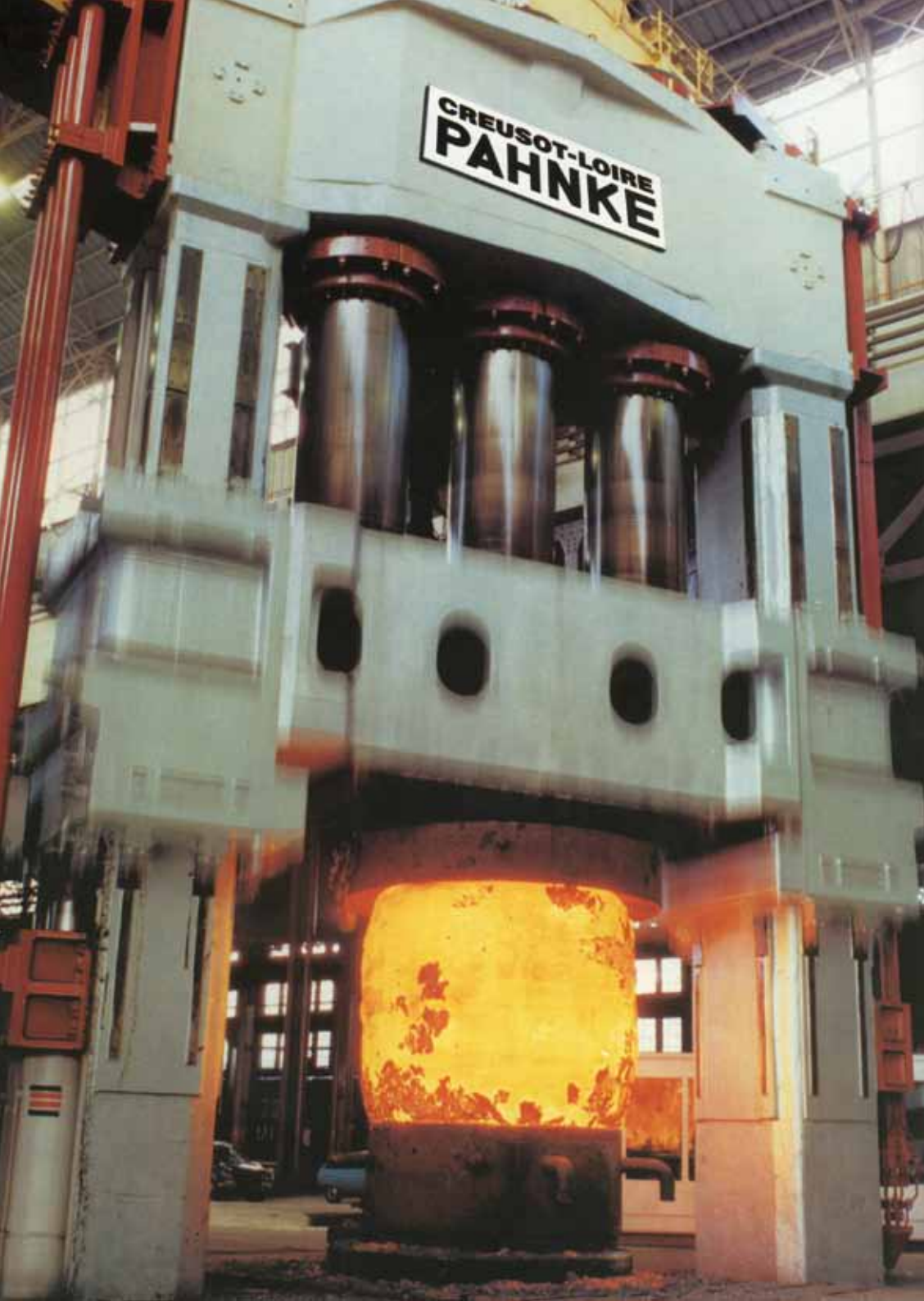
«ПАНКЕ Инжиниринг» для «Крѣзо-Луар» (1976 г.): 110 МН рама с несколькими стяжными болтами на каждую колонну (= рама с предварительным натягом)
