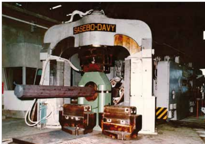
18 МН пресс нижнего давления производства фирмы «ДЭВИ»
