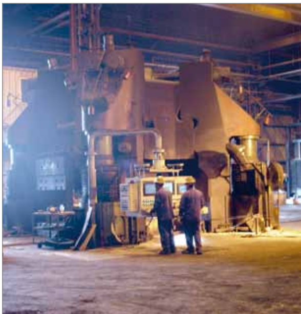
Штамповочные прессы для «Уэбер Металс»: 300/350 МН (слева) и 110 МН (посередине и справа)
