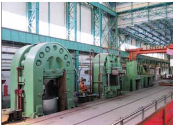
Экструзионная линия с прессами 360 и 150 МН, с приводом «PMSD» от 42 насосов «RX 500» для «Норхейнко», 2009 г.
