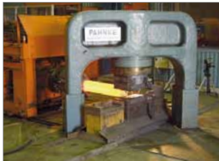
5 МН пресс свободнойковки нижнего давления для «МЕФОС» (первый пресс «ПАНКЕ» и первый привод «PMSD»)
