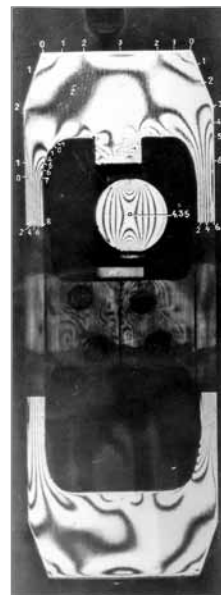
Моноблочная рама из литой стали (с испытываемым образцом под эксцентричной нагрузкой и эпюры напряжений)
