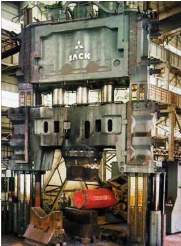
100 МН рама для фирмы «Джэпэн Кастинг & Форджинг» (1972 г.); скрепленные скобами колонны соединены болтами с поперечиной
