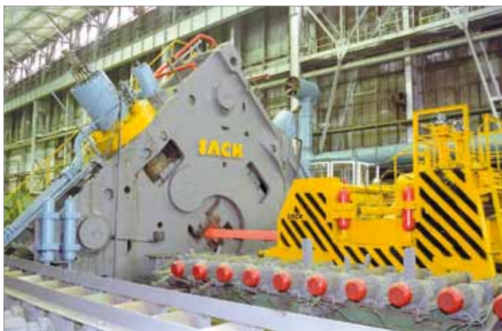
Радиально-ковочная машина «ЗАК R 800» на фирме «ВСМПО», Россия
