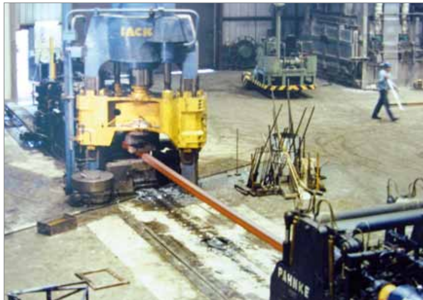
Проект Михаэля Панке на «ПСИ» (1979): привод «PMSD», два манипулятора и новое управление для 7 МН прессы на «Пресс Форж Ко.»
