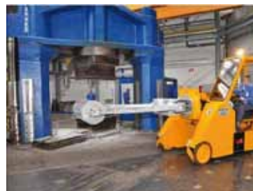
Пресс свободной ковки для «Уэбер» (конструктивно идентичный с прессом для «Фукс») с приводом «PMSD» (2009 г.)
