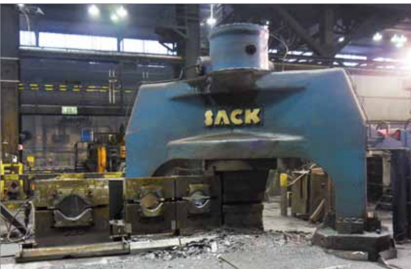
Пресс свободной ковки «ЗАК» двухколонного конструктивного типа
