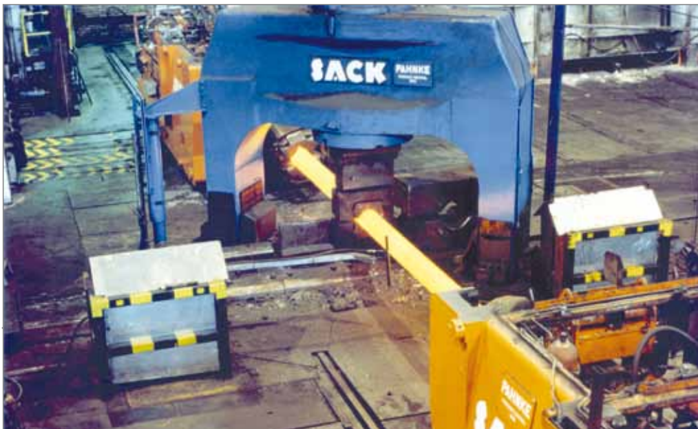
Программируемый 18 МН ковочный комплекс на фирме «Сандвикен Стил», Швеция
