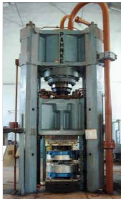
20 МН изотермический пресс со ступенями усилия 15 и 6 МН с встроенными ISO-инструментами (1986 г.)
