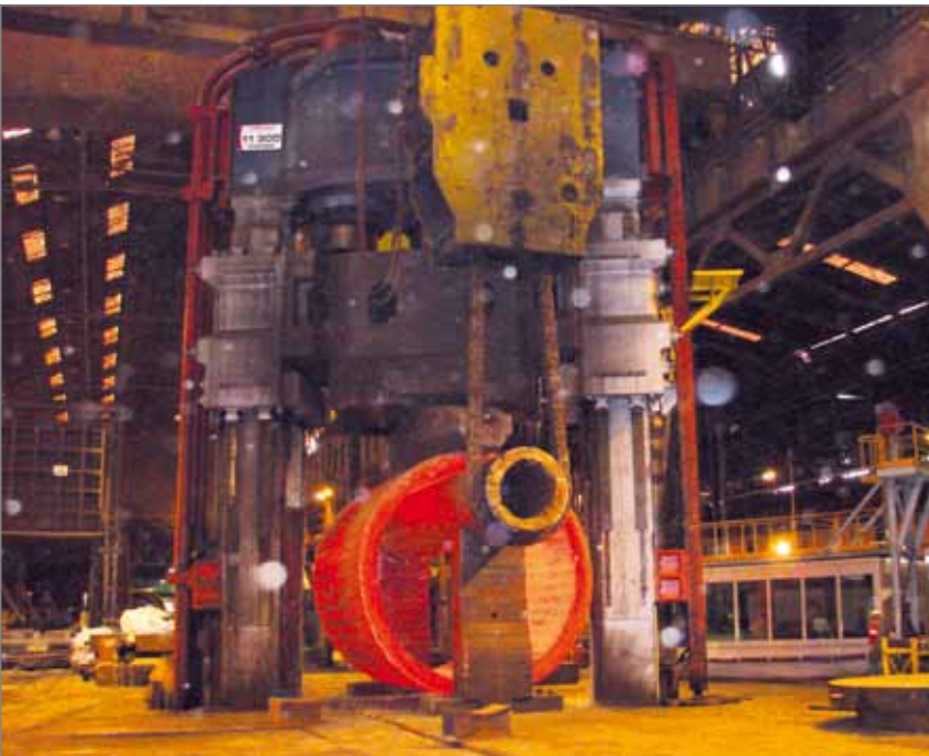
90/110 МН пресс свободной ковки верхнего давления для «Крёзо-Луар» (1976 г.)
