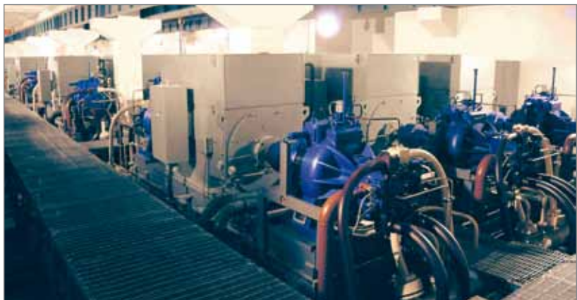
Экструзионная линия с прессами 360 и 150 МН, с приводом «PMSD» от 42 насосов «RX 500» для «Норхейнко», 2009 г.
