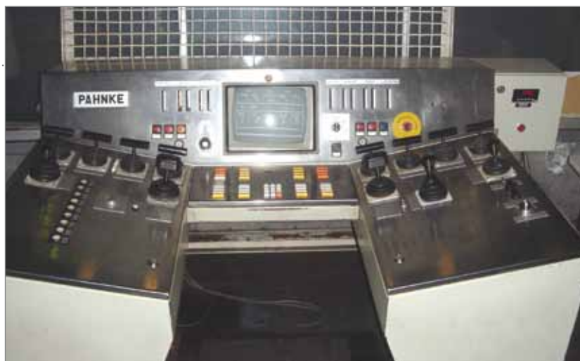
Типичный пульт управления «ПАНКЕ» для прессы свободной ковки с двумя интегрированными манипуляторами
